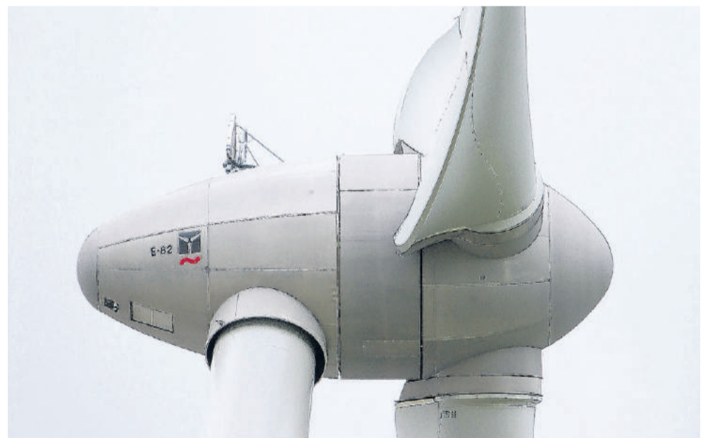
De turbine van Enercon heeft een capaciteit van 3 megawatt. Eén windmolen levert genoeg stroom voor ongeveer 1.700 huishoudens. (FOTO: DIK KUIPER)
